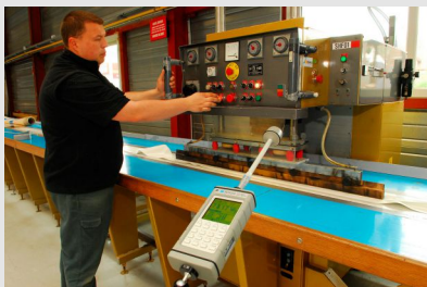
Mesure de champs électromagnétiques sur un poste de soudage haute fréquence
